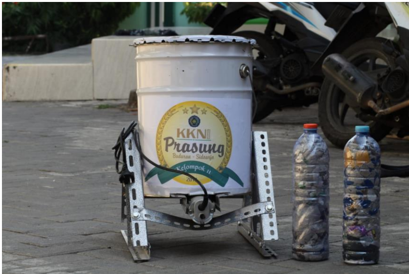
Gambar 2.3.1. Mesin Pencacah Sampah Plastik.
