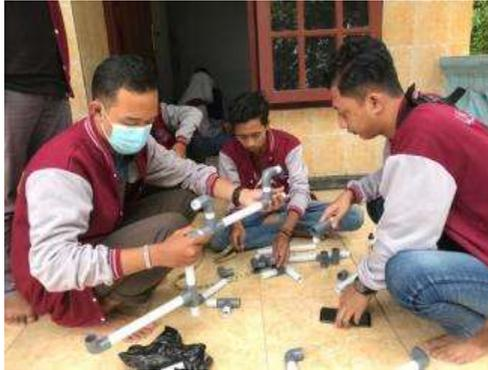
Gambar 2.1 pembuatan mesin cuci tangan otomatis
