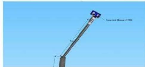
Gambar 2 Skema Sensor Jarak Yang Akan Di Gunakan Untuk Mengukur Tinggi Badan
