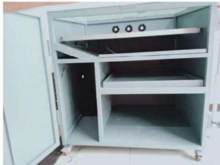
Gambar 5. Alat PLTS untuk Pengering Kupang
