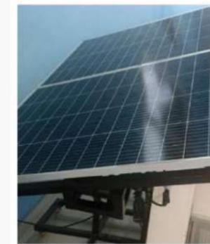
Gambar 6. Solar Panel untuk Pergerakan 2 Sumbu
