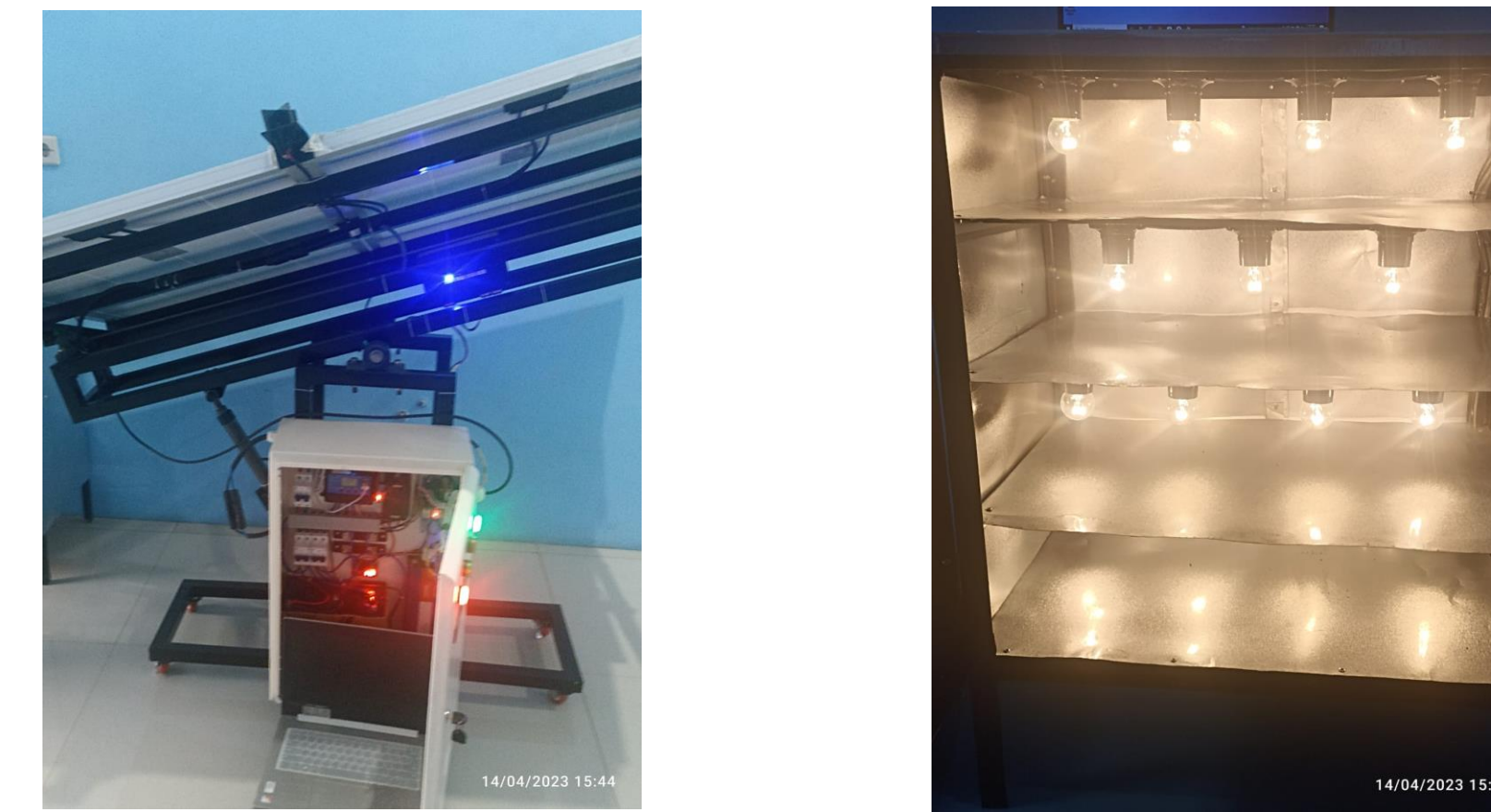
Gambar 3. Hardware Solar Tracker dan Box Pengering
